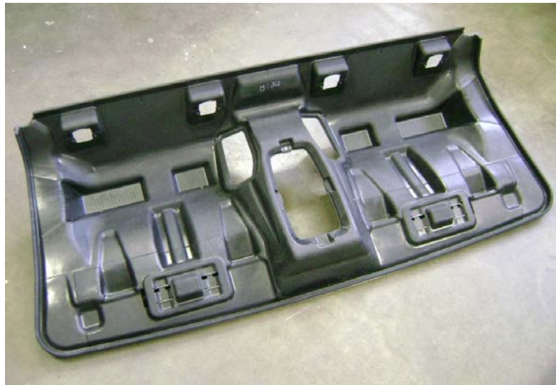
Anwendung des Recycling-Vlieses in der Hintersitzschale des BMW i3.
